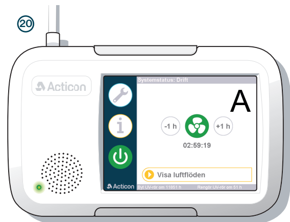
Grønt viftesymbol indikerer at timeren er startet. Driftstiden kan forkortes eller forlenges med 1 time. For å slå av timeren manuelt, trykk på det grønne viftesymbolet.
